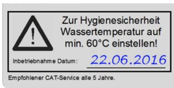
Bsp.: In der oben gezeigten Ansicht wird eine Inbetriebnahme am 22.06.2016 vorgenommen. Demnach ist der Kartuschenwechsel im Juni 2021 durchzuführen.
