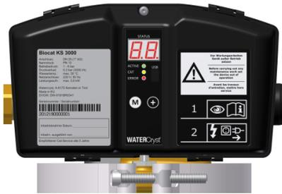
Die Steuerelektronik signalisiert die jeweiligen Betriebszustände und Störungen über ein zweistelliges Display, 3 LED und einen akustischen Signalgeber (Summer).
