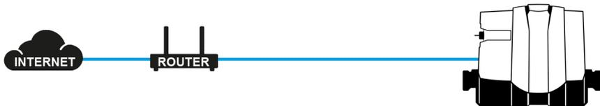
Sollte ein direkter Anschluss mittels LAN-Kabel (RJ45) von Ihrem BIOCAT-Leckageschutzgerät nicht möglich sein, können sie dies in den meisten Fällen mit einem Powerline Adapter-Set über die vorhandene Schuko-Steckdose realisieren. Wir empfehlen dazu folgendes Zubehör:
