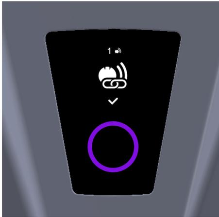
⇒ Der Bodensensor ist jetzt erfolgreich mit dem BIOCAT-Leckageschutzgerät verbunden
