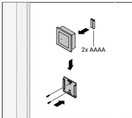
1. Am Montageort der Steuerung in Normhöhe die Wandhalterung mit den mitgelieferten Schrauben und Dübeln an der Wand befestigen, sodass die Beschriftung OBEN nach oben zeigt.
