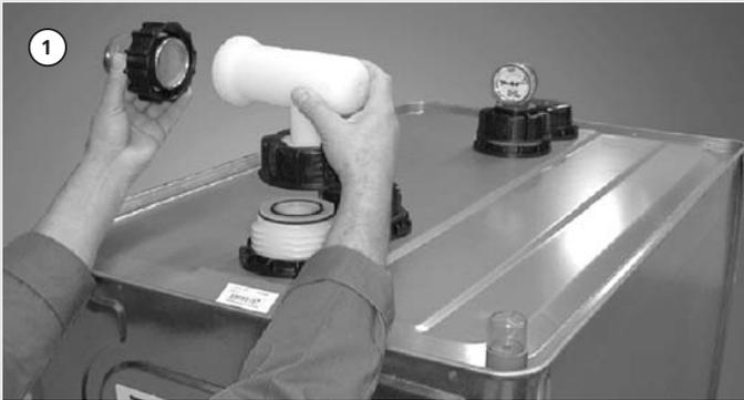
DWT plus 3 auf Fußgestell, KWT auf Boden aufsetzen. Füllstanduhren (Pflicht bei DWT plus 3, bei KWT optional) in Gewindebuche auf 3. Tankstutzen einschrauben. Winkel-Füllrohr mit Füllanschluss LORO-X auf 1. Tankstutzen mit eingesetztem Tauchrohr aufsetzen; O-Ringe einfetten Schutzschlauch von der Düse entfernen.
