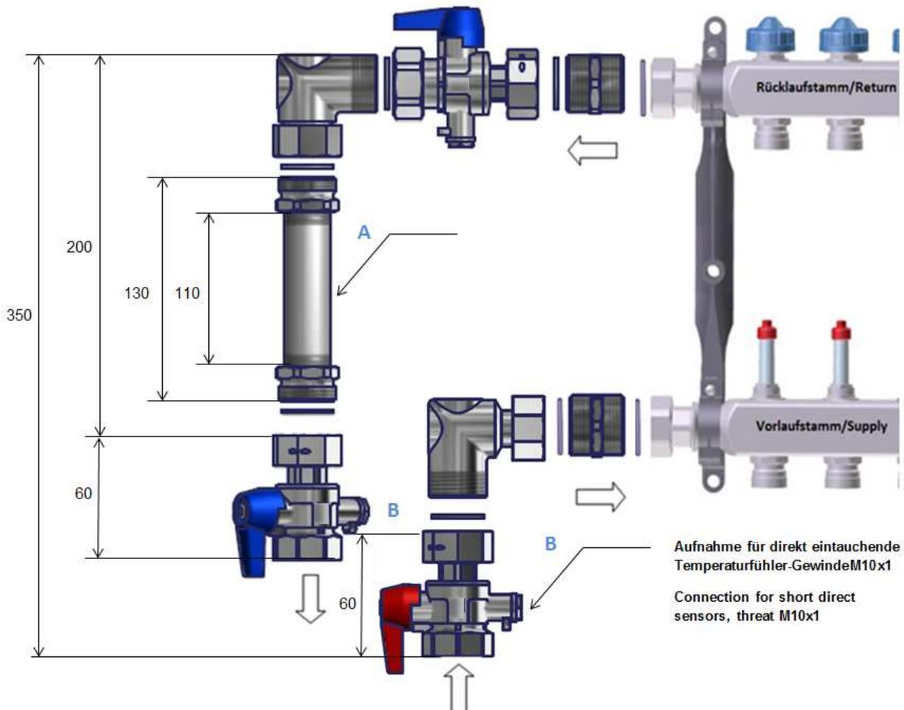
Das Wärmemengenzähler-Set senkrecht kann in Kombination mit dem Heizkreisverteiler mit Durchflussanzeige eingesetzt werden.
