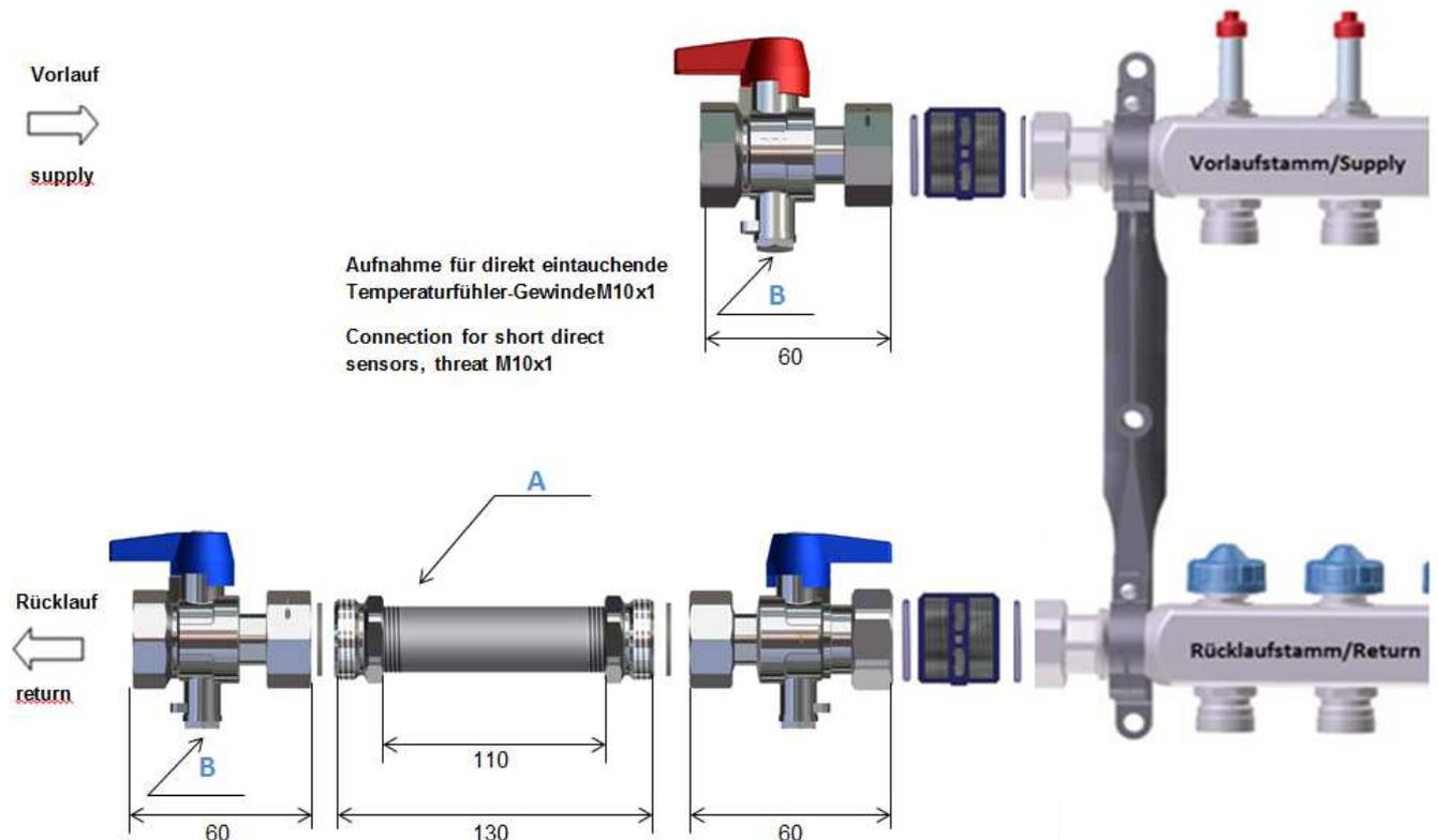
Das Wärmemengenzähler Einbauset waagrecht kann in Kombination mit dem Heizkreisverteiler mit Durchflussanzeige eingesetzt werden.
