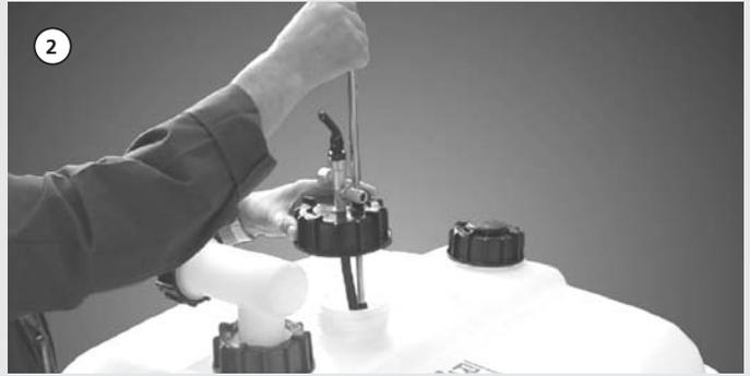
Entnahme-Sammelarmatur mit Grenzwertgeber und Flachdichtung Ø 85 / Ø 68 mm x 3 mm auf 2. Tankstutzen aufsetzen.
