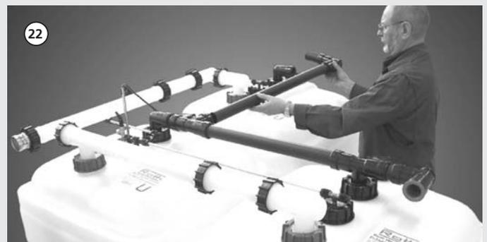
... auch hierbei zuerst die Leitungen für die einzelnen Reihen und danach das Sammelrohr montieren. Fertig montierte Leitungssysteme.
