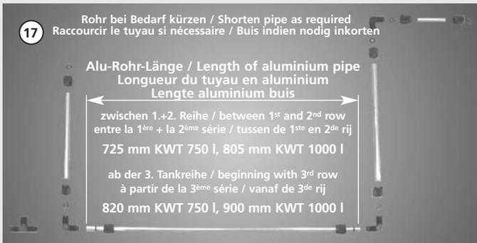
Entnahme-Sammelleitung vormontieren. Das Beispiel zeigt die Leitung für 2 Tankreihen. Das T-Stück „T“ wird ab 3 Tankreihen an jeder Leitungskreuzung benötigt, wobei das Winkel-Stück „W“ am Leitungsabgang für die hinterste Tankreihe eingesetzt wird.
