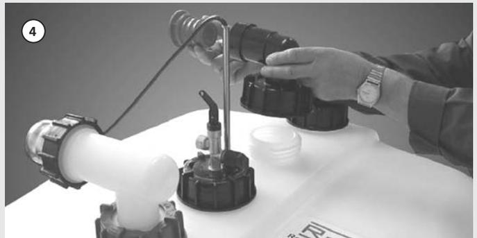
Winkel-Entlüftungsstück (Pos. 8) mit Anschlagdichtung (Pos. 15) und Flachdichtung Ø 85 / Ø 68 mm x 3 mm auf 3. Tankstutzen aufsetzen.
