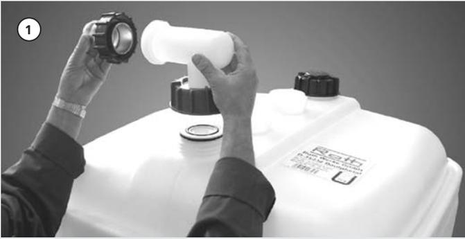
Winkel-Füllrohr (Pos. 2) und Füllanschluss (Pos. 6) auf ersten Tankstutzen mit eingesetztem Tauchrohr aufsetzen; vorher Schutzschlauch von der Düse entfernen; O-Ringe einfetten.
