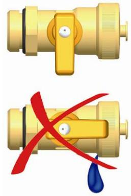
18. Nehmen Sie die Schläuche der Spül- und Befüllstation ab und schrauben Sie die Verschlusskappen auf die Befüll- und Entleerhähne.
