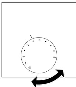
Die Bedienung des Reglers erfolgt bequem über den Sollwertsteller. Durch simples Drehen wird die gewünschte Temperatur vom Benutzer eingestellt.
