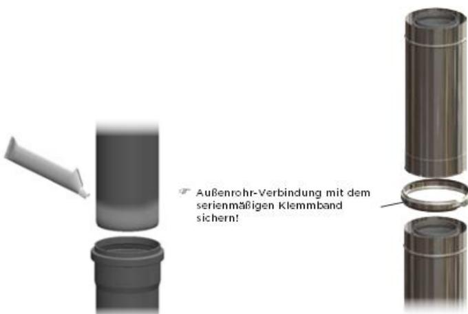
Abb. 1, PP-Rohrende einfetten
