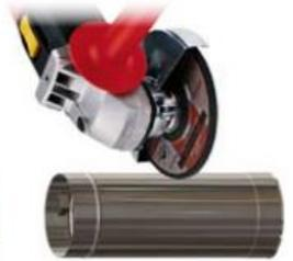
Abb. 05, Rohre kürzen u. entgraten
