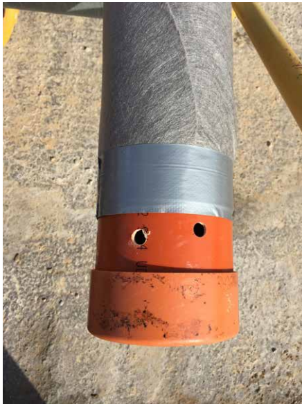
Perforiertes KG-Rohr als Aufnahme für den Grundwasserpeilstab
