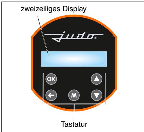
Abb. 11: Bedienfeld der Enthärtungsanlage
