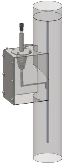
Der OekoTube-Inside Standard besteht konstruktiv aus einem Abscheiderohr, einer Isolator-kammer, einem Isolator und einer Elektrode (ohne Reinigungskorb).
