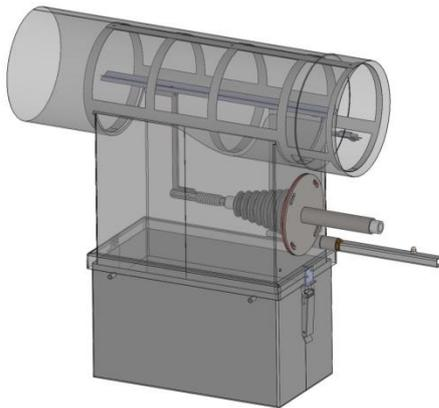
Der OekoTube-Inside mit halbautomatischer Reinigung und Staubsammelbox besteht konstruktiv aus einem Abscheiderohr, einem Reinigungskorb, einer Isolator-kammer, einem Isolator, einer Staubsammelbox und einer Elektrode. Mittels Betätiger wird der Reinigungskorb auf der Innenseite des Abscheiderohrs manuell aktiviert. So werden die Abscheidefläche und die Elektrode vom Staub befreit. Der Staub fällt in die Staubsammelbox. EMPFEHLUNG: nur für waagrechte Montage.
