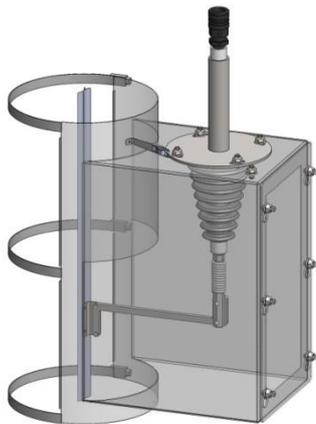
Der OekoTube-Inside Nachrüstsatz besteht konstruktiv aus einer Isolator-kammer, einem Isolator und einer Elektrode (ohne Reinigungskorb). Er wird an einem bestehenden Kaminrohr mit Schellen fixiert. Beim Kaminrohr muss die entsprechende Öffnung ausgeschnitten werden. Die Schablone wird mitgeliefert.
