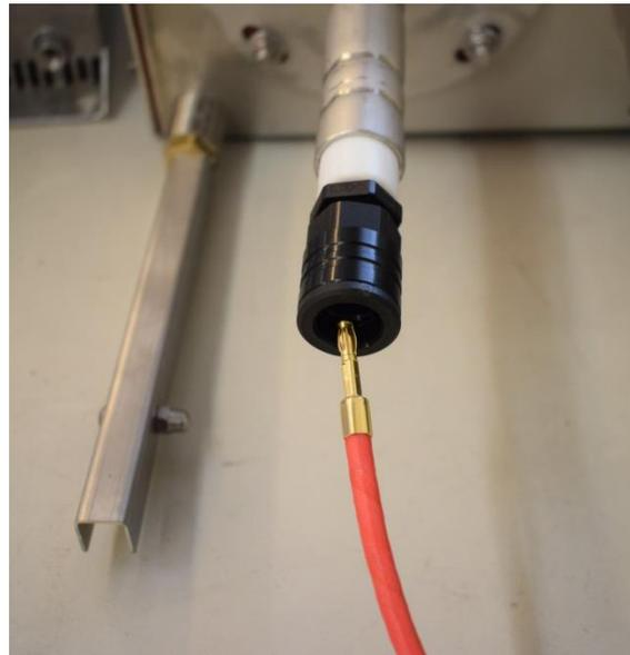
4. Das Hochspannungskabel in die Steuerungsbox einstecken. Der Bananenstecker muss richtig eingesteckt sein. Bei leichtem Zurückziehen muss ein Widerstand spürbar sein.
