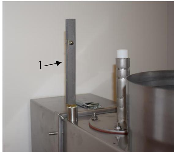
4. In der Position (2) berührt der Reinigungskorb den Elektrodenhalter und reinigt die Elektrode.
