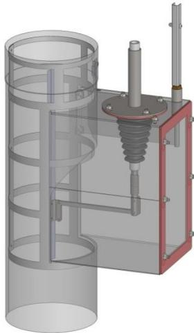
Der OekoTube-Inside mit halbautomatischer Reinigung besteht konstruktiv aus einem Abscheiderohr, einem Reinigungskorb, einer Isolator-kammer, einem Isolator und einer Elektrode. Mittels Betätiger wird der Reinigungskorb auf der Innenseite des Abscheiderohrs manuell aktiviert. So werden die Abscheidefläche und die Elektrode vom Staub befreit.
