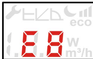
Abb. 16: Anzeige Fehlermeldung E8 (Motorfehler)
