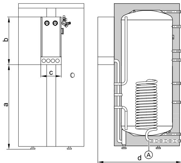
Für die Montage der Solar-Divicon werden die Rohrbögen (A) zur Vorderseite des Heizwasser-Pufferspeichers gedreht.
