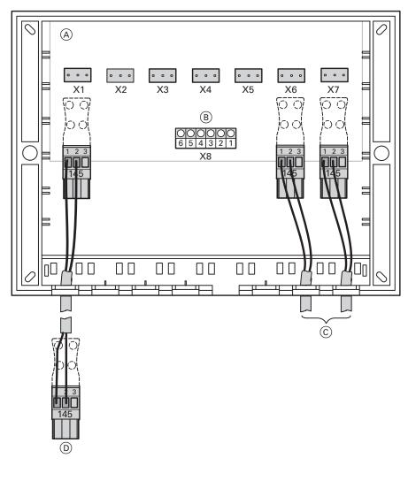
1. Zubehör an Klemmen "1" und "2" im Stecker 145 bzw. an Klemmenleiste "X8" im KM-BUS-Verteiler (an Klemmen "1" und "2", "3" und "4" bzw. "5" und "6") anschließen.
