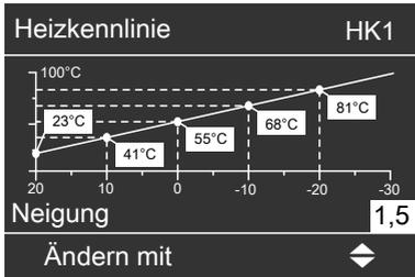
In Abhängigkeit von verschiedenen Außentemperaturen (dargestellt auf der waagerechten Achse) werden die zugeordneten Vorlauf-Solltemperaturen für den Heizkreis weiß hinterlegt angegeben.
