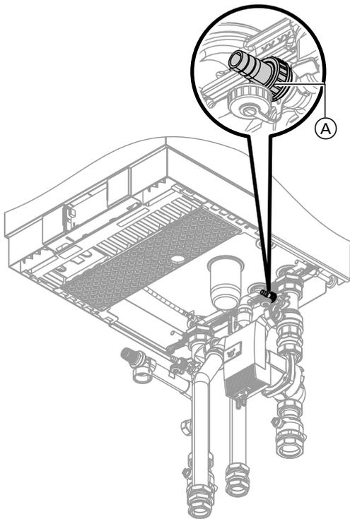
1. Vordruck des Membran-Druckausdehnungsgefäßes prüfen.
