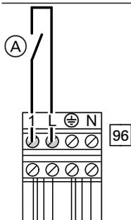
(A) Potenzialfreier Kontakt (bei Anschluss Brücke zwischen L und 1 entfernen)
