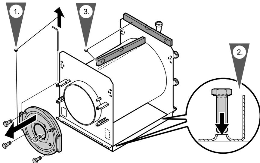
Heizkessel mit geringer Steigung nach hinten ausrichten.
