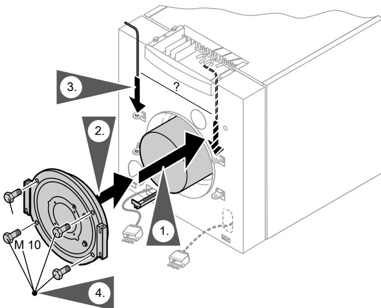
Brennkammer bis zum Anschlag einschieben (Haltebügel nach unten).
