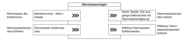
Das Objekt "Warmwassertemperaturregelung" bietet die Möglichkeit, die Warmwasserbereitung der Heizungsanalge zu beeinflussen. Die Warmwasserregelung in der Regelung kann über die Codieradresse "00" deaktiviert sein. Dann ist dieses Funktionsobjekt außer Funktion
