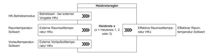
Das Objekt "Heizkreisregler" bietet die Schnittstelle der Heizungsregelung zur Einzelraumregelung. Für jede in der Regelung enthaltene Heizkreisregelung stellt das Kommunikationsmodul ein Funktionsobjekt dieser Art zur Verfügung.
