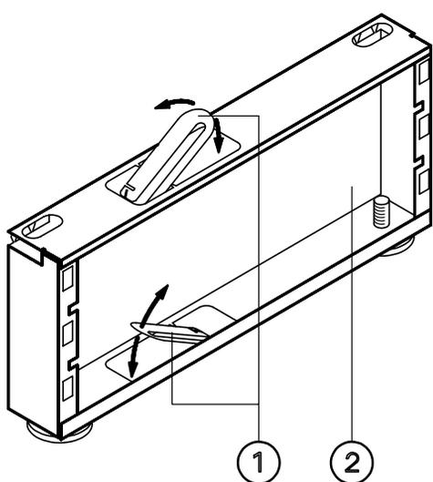
1. Vier Montageschlüssel ① (werden später als Unterlegscheiben benötigt) aus Rahmenteilen ② entfernen.
