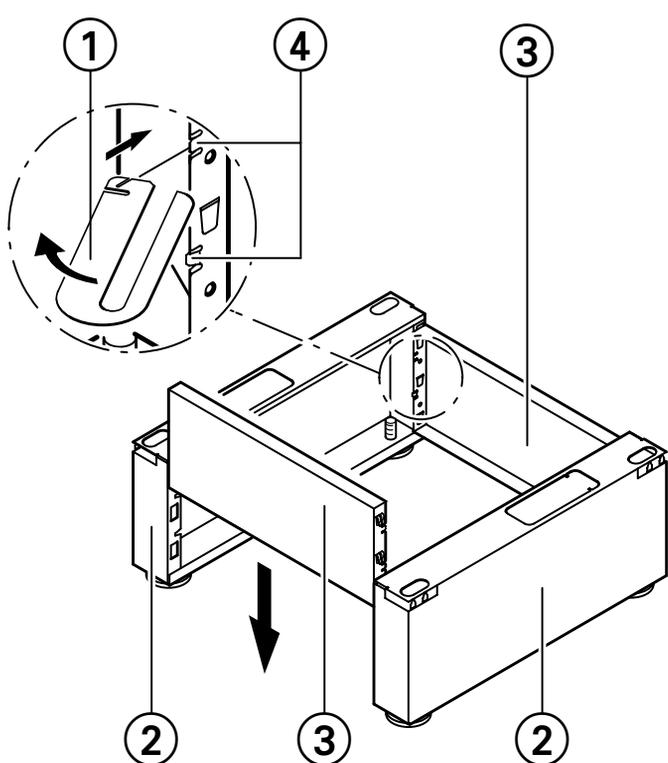
2. Seitenbleche ③ bis zum Anschlag in die Rahmenteile ② einstecken.
