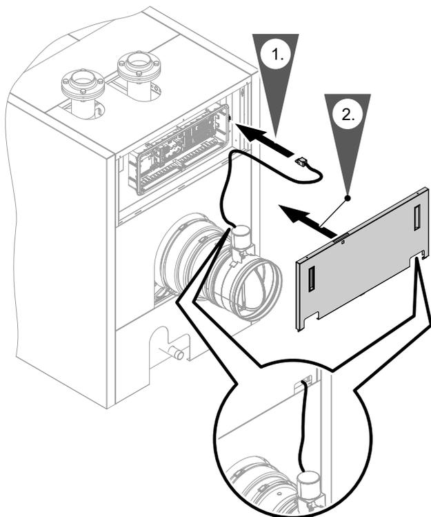
1. Anschlussleitung des Motors zum Gegenstecker rechts an der Kesselrückseite führen. Stecker in den Gegenstecker einstecken.
