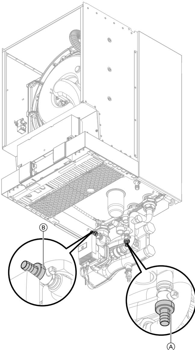
1. Vordruck des Membran-Druckausdehnungsgefäßes prüfen.
