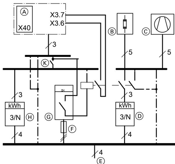
Abb. 33 Darstellung ohne Sicherungen und ohne FI-Schutzschalter
