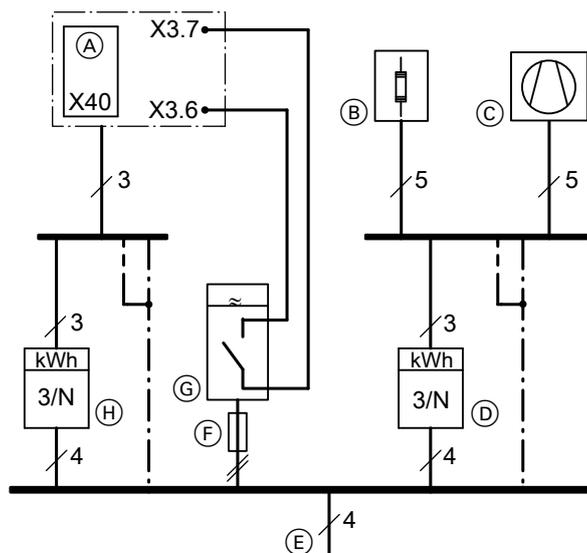
Abb. 32 Darstellung ohne Sicherungen und ohne FI-Schutzschalter
