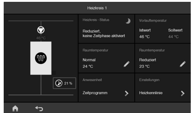
Abb. 4 Beispiel: Bedienebene 1 für Heizkreis
