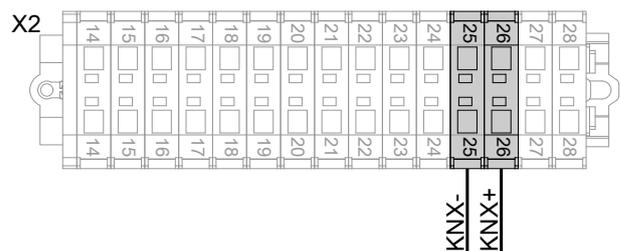
Abb. 34 Anschlüsse KNX-PL-Link Schnittstelle
