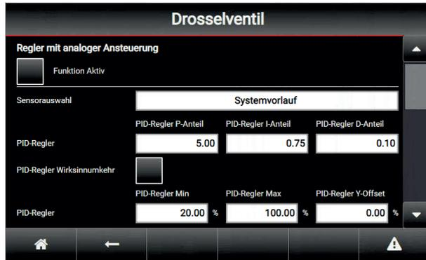
Falls ein Pufferentladeventil zusätzlich zur Entladepumpe vorhanden ist (siehe Abbildung), kann dieses über den analogen Ausgang AA 2 angesteuert werden.
