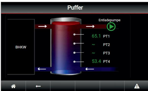
Die aktuellen Temperaturen des Pufferspeichers werden angezeigt. Es sind 4 Temperaturfühler möglich. Standardmäßig sind die Temperaturfühler PT1 und PT4 angeschlossen.
