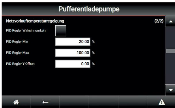
Für die Netzvorlauftemperaturregelung gibt es die Möglichkeit, zwei verschiedene Sollwerte einzustellen, einen niedrigeren für normale Heizung und einen höheren Sollwert für Warmwasserbereitung. Die Auswahl, welcher Sollwert aktiv sein soll, erfolgt über die digitalen Eingänge DE2 und DE3. Stehen beide Eingänge gleichzeitig an, wird der höhere Sollwert verwendet.
