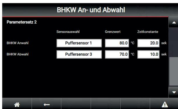
Wenn der digitale Eingang DE1 des Puffer Management Systems beschaltet wird, wird auf den 2. Parametersatz umgeschaltet.
