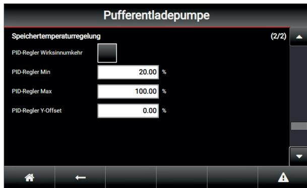
Mit der Puffertemperaturregelung kann eine übermäßige Entladung des Pufferspeichers verhindert werden. Die Puffertemperatur darf den eingestellten Sollwert nicht unterschreiten.
