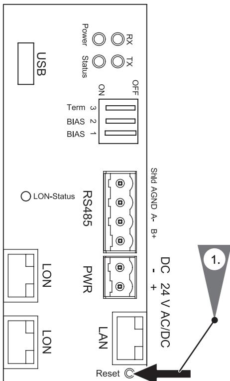
1. Appuyer sur la touche Reset pendant 1 à 2 secondes avec l'outil fourni ou avec un autre objet fin.
