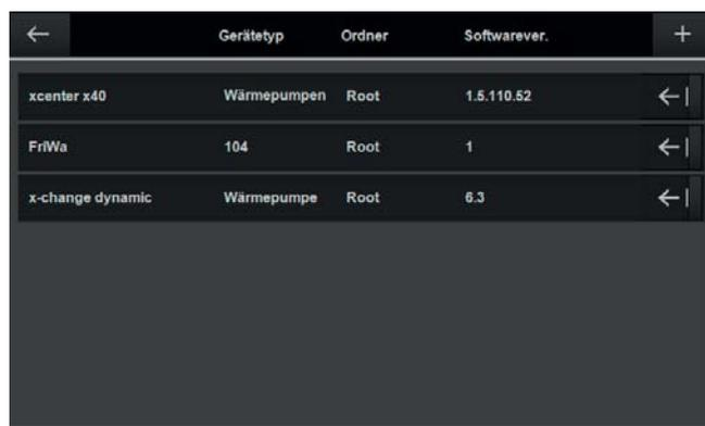
9. Alle Einstellungen der Frischwasserstation werden jetzt in der Regelung der Wärmepumpe eingestellt. Beachten Sie hierzu die Hinweise in ► Betrieb Frischwasserstation, Seite 16.
