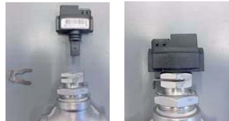
2. Das Anschlusskabel des Drucksensors ist durch leichte Bewegung nach rechts und links aufzustecken - 2 x Click ist zu hören.
