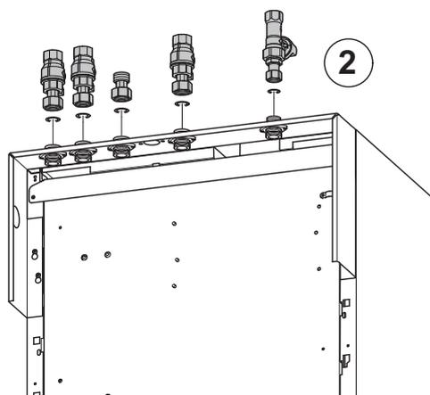
2. Kugelhähne und Verschraubung mit Dichtungen gemäß Abb. an den Anschlussbuchsen der Konsole montieren
