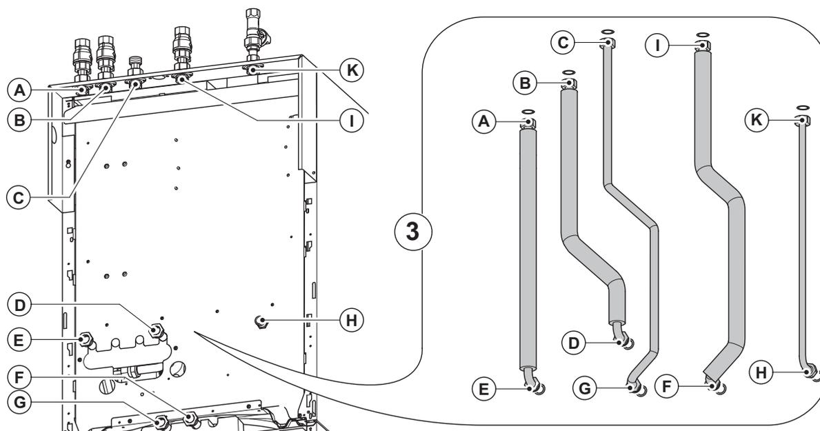
3. Rohre mit Dichtungen gemäß Abb. an den jeweils gekennzeichneten Anschlüssen montieren
