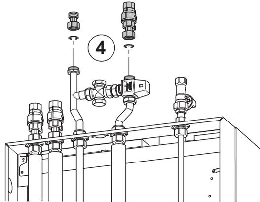
4. Kugelhahn mit Dichtung gemäß Abb. am rechten Anschluss der Mischventilgruppe montieren
