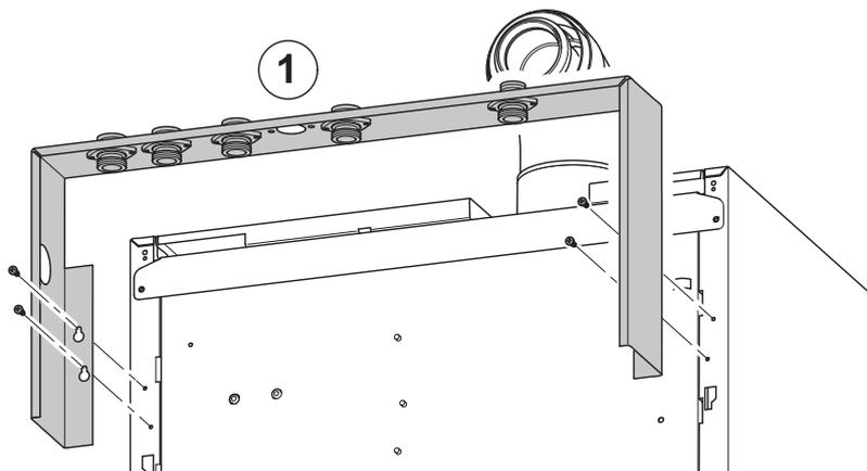
1. Konsole gemäß Abb. mit 4 Schrauben an der Rückseite des Heizkessels montieren
