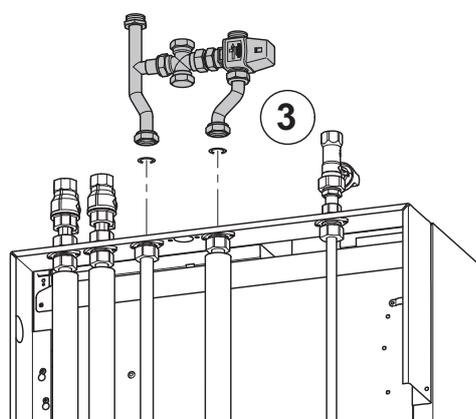
3. Vormontierte Mischventilgruppe mit Dichtungen gemäß Abb. an den Anschlussbuchsen der Konsole montieren
