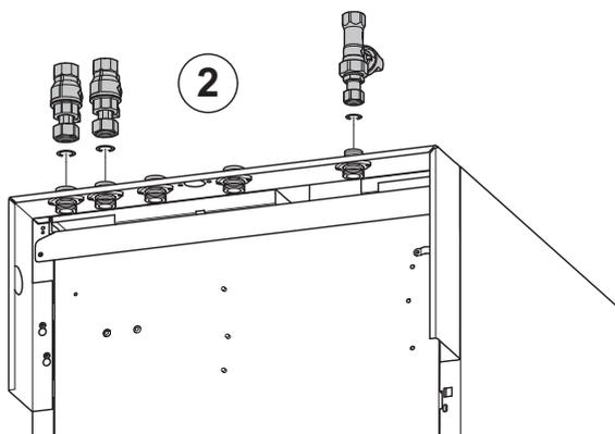
2. Kugelhähne mit Dichtungen gemäß Abb. an den Anschlussbuchsen der Konsole montieren
