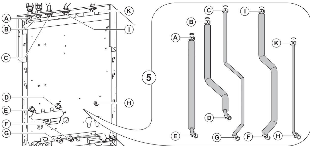
6. Rohre mit Dichtungen gemäß Abb. an den jeweils gekennzeichneten Anschlussbuchsen montieren
