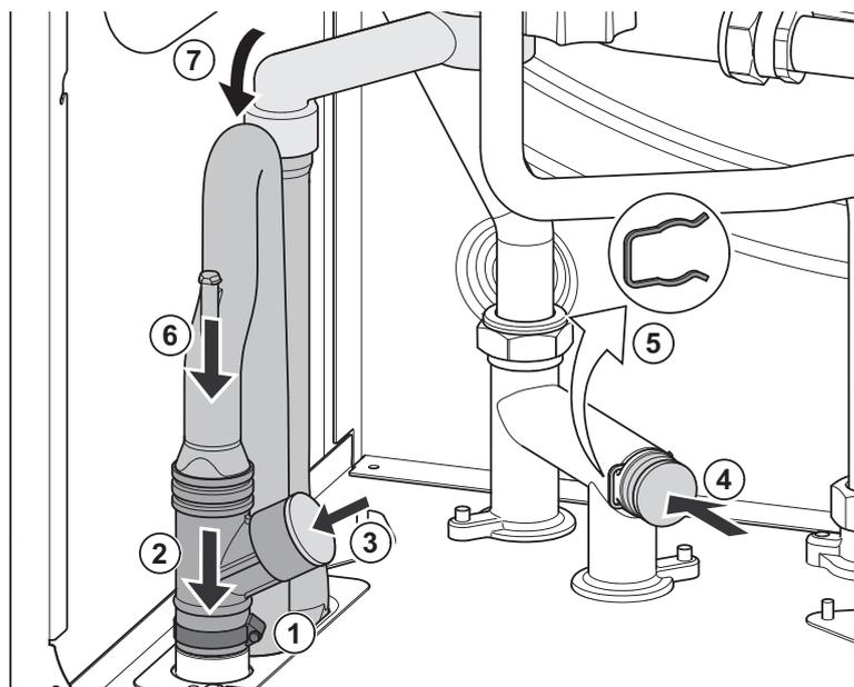
1. Schlauchschelle am neuen Schlauchverbinder anbringen.
