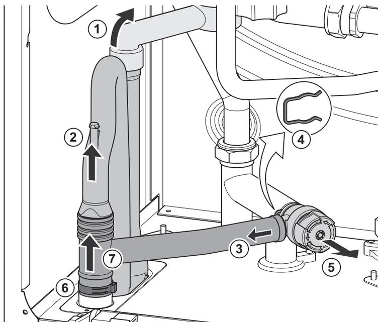
1. Verbindungsschlauch zur Kondensat-Sammelschale vom Siphon lösen.
