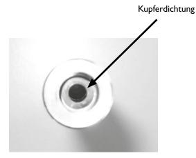
(2) Soledruckwächter aufschrauben bis er dicht abschließt. Die Kupferdichtung darf dabei nicht verrutschen.
