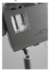
(3) Das Ende mit dem Außengewinde R 3/8" in die Soleleitung gemäss Hydraulikschema mit Teflonband eindichten.
