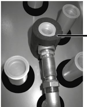
2. Restliche Verrohrung des Zirkulationsanschlusses mit 220 mm langen Isolationsschlauch (1) isolieren.
