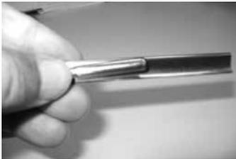
1. Fühler an Außenseite der Fühlerfeder anlegen.
