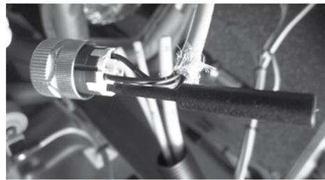
Die einzelnen Adern des Bus-Kabels mit dem beigelegtem Werkzeug am Stecker anschliessen
