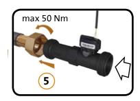
Die Wärmemengenerfassung (5) über das Verschraubungsteil an das Rohr anschliessen
