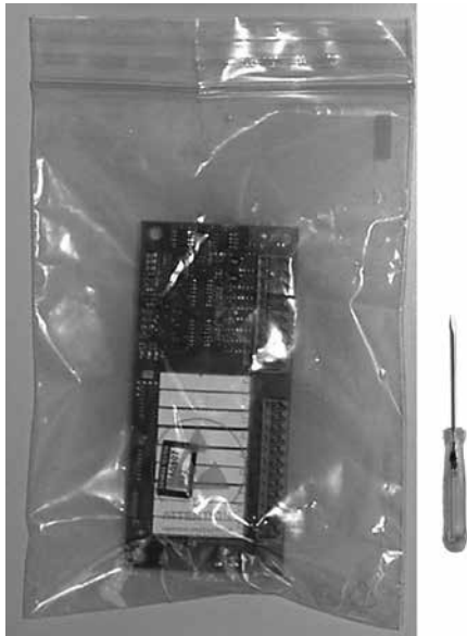
Erweiterungsplatine mit Mini-Schraubendreher für Anklebmarbeiten Betriebsanleitung
