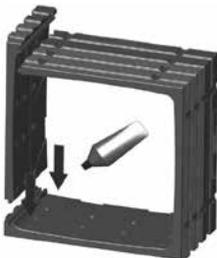
5. Die bereits zusammengesteckten Teile erneut um 90° drehen und die letzte Verbindung herstellen.
