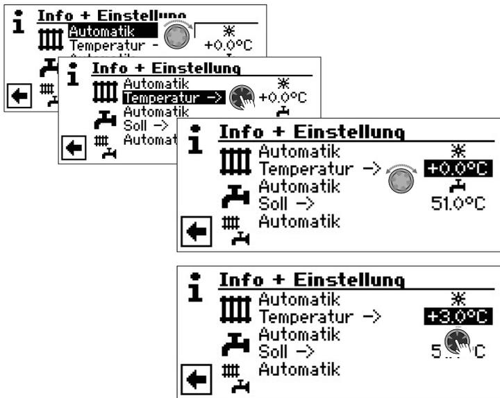
Eingabe durch Drücken des „Dreh-Druck-Knopfs“ beenden. Die gewünschte Temperatur wird dadurch gespeichert.
