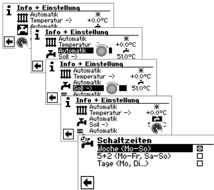
→ Die Programmierung der Schaltzeiten für die Trinkwarmwasserbereitung erfolgt wie im Abschnitt „Einstellen der Schaltzeiten des Heizkreises“ (ab Seite 11) beschrieben.
