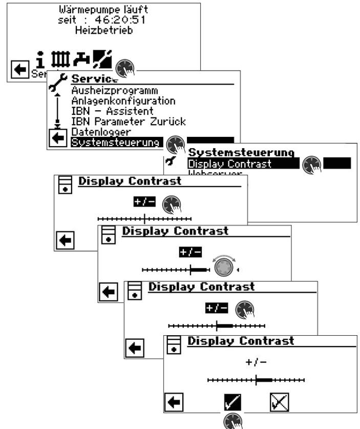
Durch Drehen des „Dreh-Druck-Knopfes“ den Kontrast anpassen
