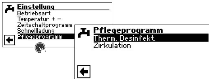
Die thermische Desinfektion ermöglicht, die Trinkwarmwassertemperatur mit einem zusätzlichen Wärmeerzeuger (ZWE) auf eine höhere Temperatur zu bringen als jene, die mit der Wärmepumpe erreichbar ist. Die thermische Desinfektion wird ausschliesslich über zusätzliche Wärmeerzeuger bereitet; der Verdichter der Wärmepumpe bleibt ausgeschaltet.
