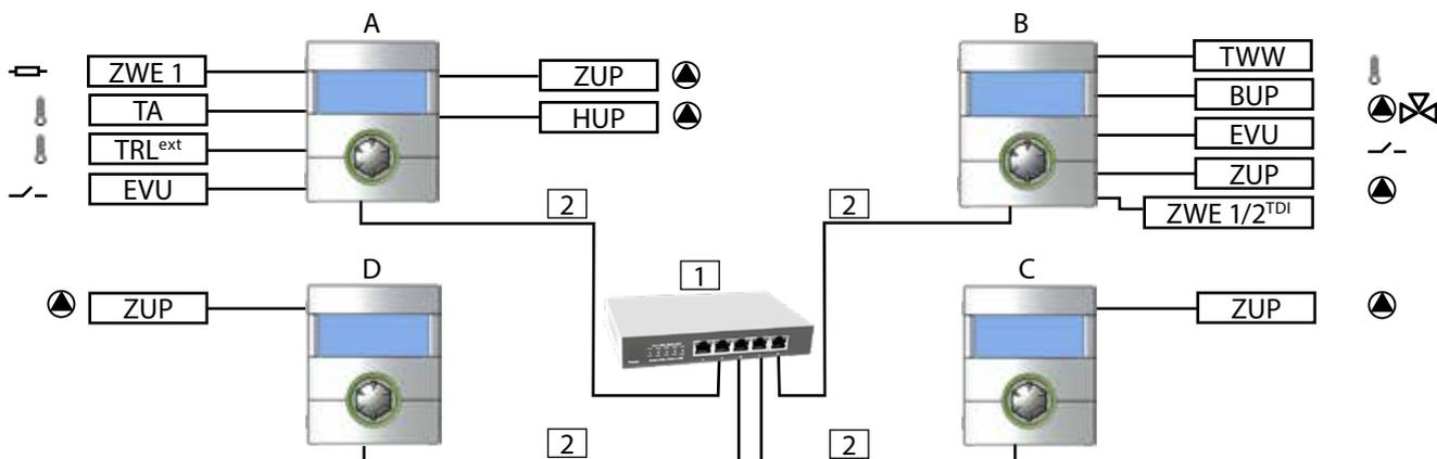
Beispiel 2: Verbindung über die Ethernet-Schnittstellen der Bedienteile
