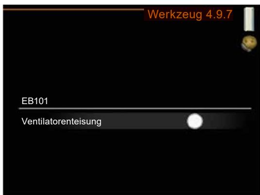
Bei einer stark vereisten Wärmepumpe kann eine „Ventilatorenteisung“ ergänzend zur automatisch stattfindenden Enteisung erforderlich sein.
