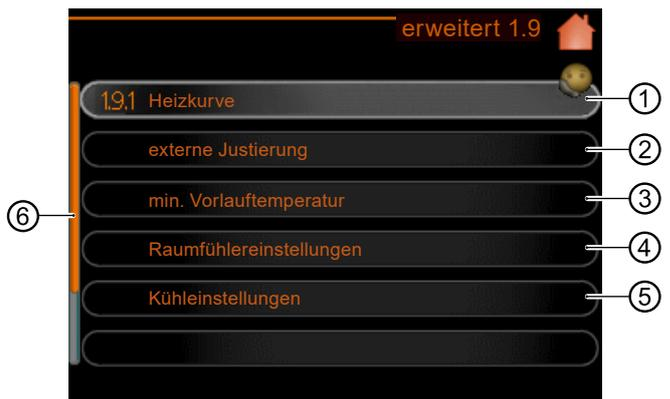
① Heizkurve Einstellung des Kurvenverlaufs für Heizung bzw. Kühlung.
