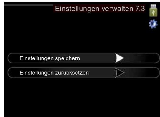
Mithilfe von „Einstellungen speichern“ werden die Menüeinstellungen auf dem USB-Stick gespeichert, um sie später wiederherstellen zu können oder um sie auf eine andere Regelungseinheit zu kopieren.
