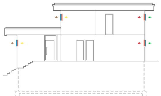
Dank der dezentralen Anordnung der Lüftungsgeräte in den Außenwänden arbeitet das System äußerst effizient und bietet somit eine optimale Raumdurchströmung mit Frischluft.
