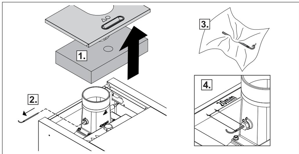
1. Isolierdeckel und Wärmedämmung abnehmen
