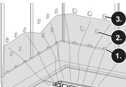
**Empfehlung:** Die Asche auf der Brennkammer nicht bei jedem Anheizen entfernen, sondern nur wenn die mittlere Lochreihe der Verkleidungsbleche nicht mehr sichtbar ist. So wird die Brennkammer geschützt und das Anheizen funktioniert besser.
