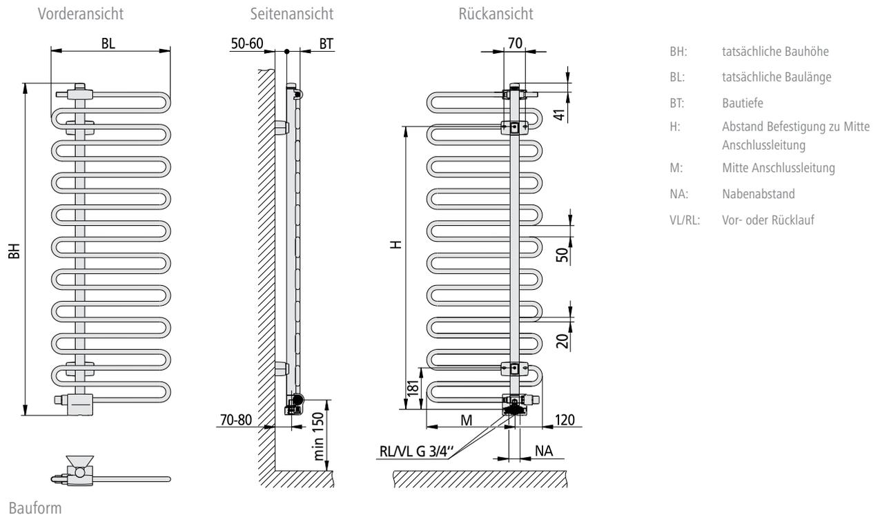
Abstand Unterkante Heizkörper zu Boden min. 150 mm.
