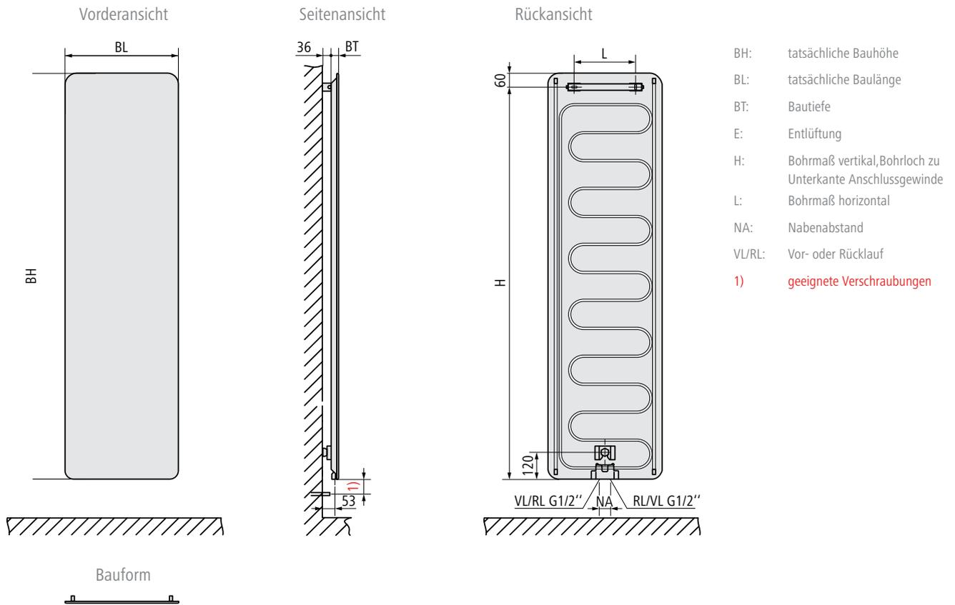
Abstand Unterkante Heizkörper zu Boden min. 150 mm.
