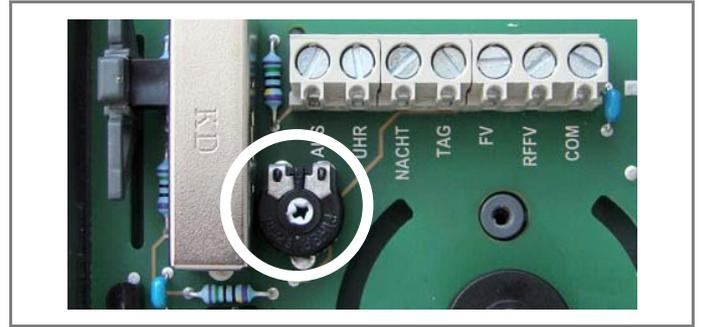
Bei Abweichung der vom Raumfühler gemessenen Temperatur zur tatsächlichen Raumtemperatur kann mit dem Potentiometer auf der Platine der Fühler um  $\pm 2^{\circ}\text{C}$  nachjustiert werden.
