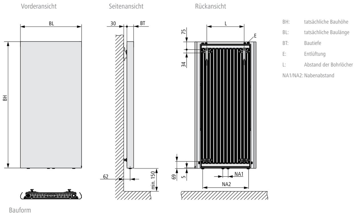
Abstand Unterkante Heizkörper zu Boden min. 150 mm.
