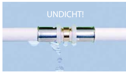
Bei üblichem Anlagendruck geprüfter, unverpresster Fitting (unverpresst-undicht)
