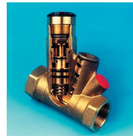
Das Schnittbild zeigt den MTCV in seiner Grundversion A. Ein im Ventilkegel montiertes Thermoelement bewirkt, dass das Ventil auf Temperaturänderungen reagiert.
